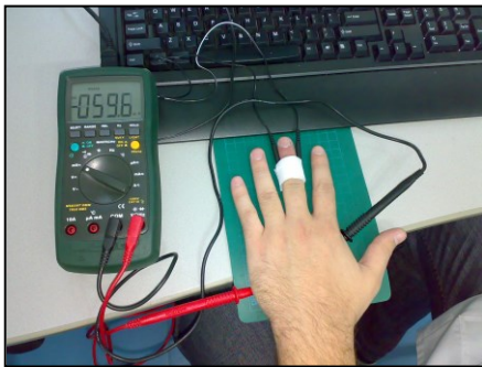
Fig. 7 Amplasamentul electrozilor de masura
