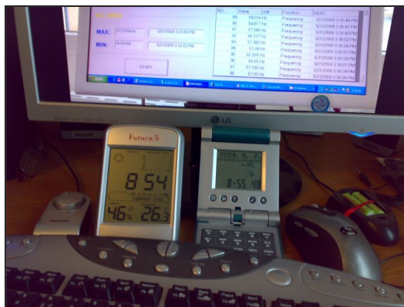
Fig. 8 Temperatura maxima si umiditatea au fost monitorizate cu ajutorul unui sistem Futura
